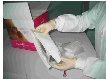
Colocar os sacos “95 KPa Specimen Transport Bag”, entre 2 panos absorventes e os acumuladores, dentro do saco de fecho hermético. **O datalogger também deve ser colocado dentro do saco de fecho hermético.**
